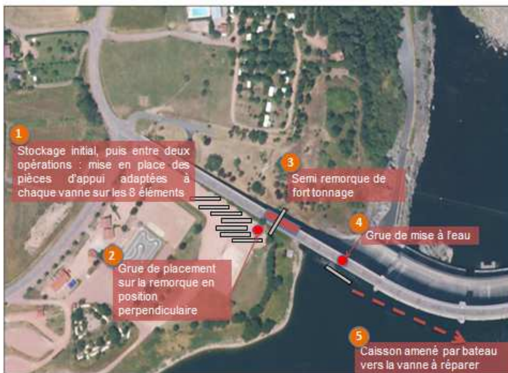
Principe de mise à l'eau des caissons
