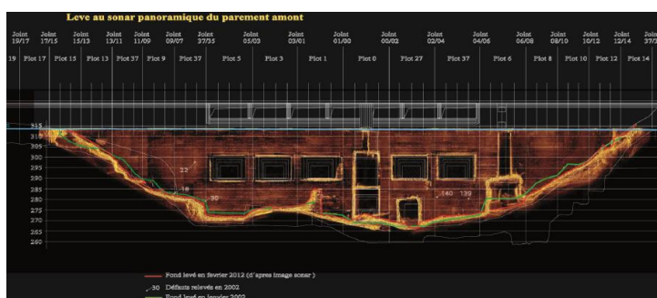
Vue sonar du barrage, côté amont
