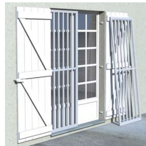
Mise en place de grilles de portes devant des portes-fenêtres.
