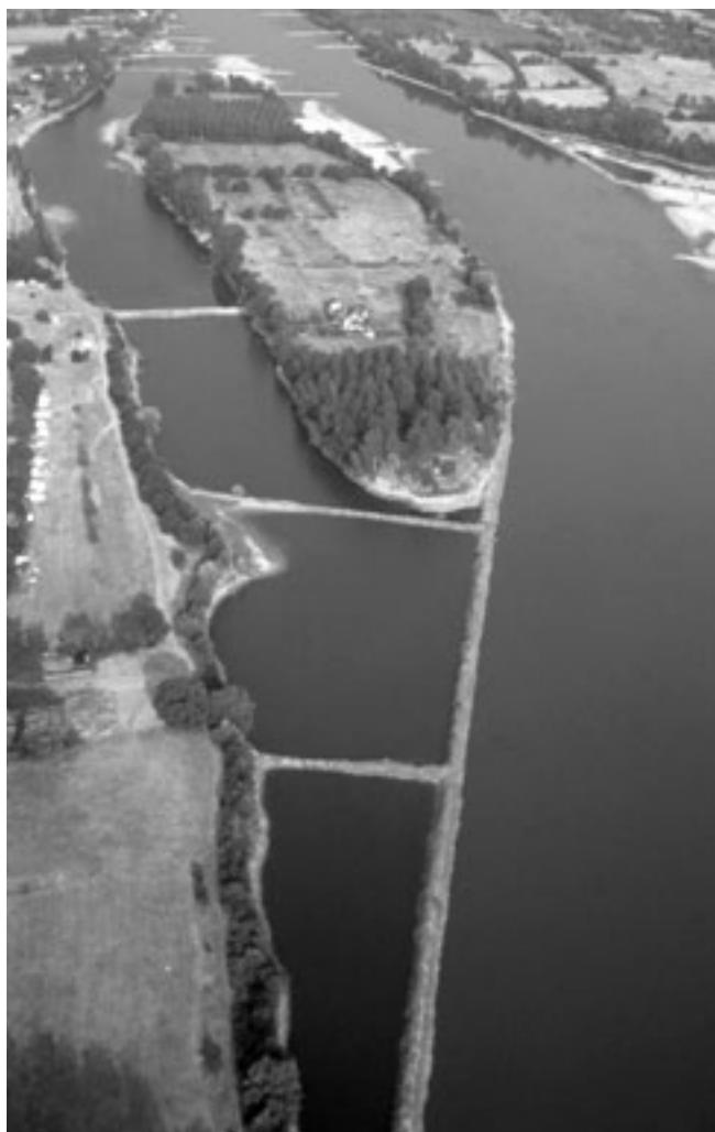
Fig. 4-8. En aval du confluent de la Maine, le lit de la Loire est parsemé de grandes îles souvent habitées (île Briand, Drouet). Des épis ont été construits pour concentrer les eaux dans un chenal rendu ainsi navigable.
