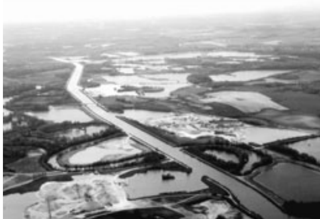
Fig. 2-15. État actuel du site de la Bassée. Le canal à grand gabarit aggrave les risques d'inondation et appauvrit l'écosystème. L'extraction des sables et graviers n'a pas été faite selon un plan paysager d'ensemble. Des réalisations économiques, touristiques et de loisirs devraient compléter l'aménagement du site (cliché IIBRS).
