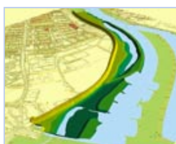
Déplacement de digue : situation future. (Arnhem, Pays-Bas)
