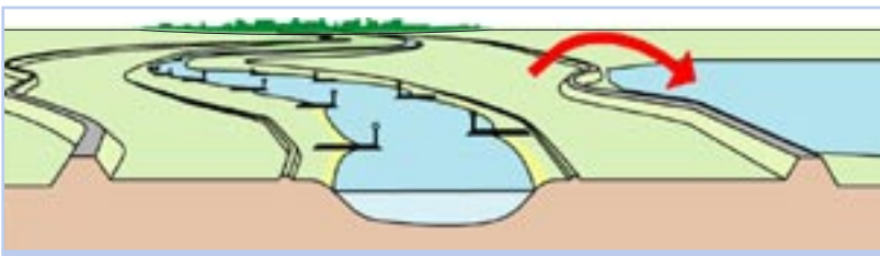
Stockage derrière les digues le long du Rhin en Allemagne.
