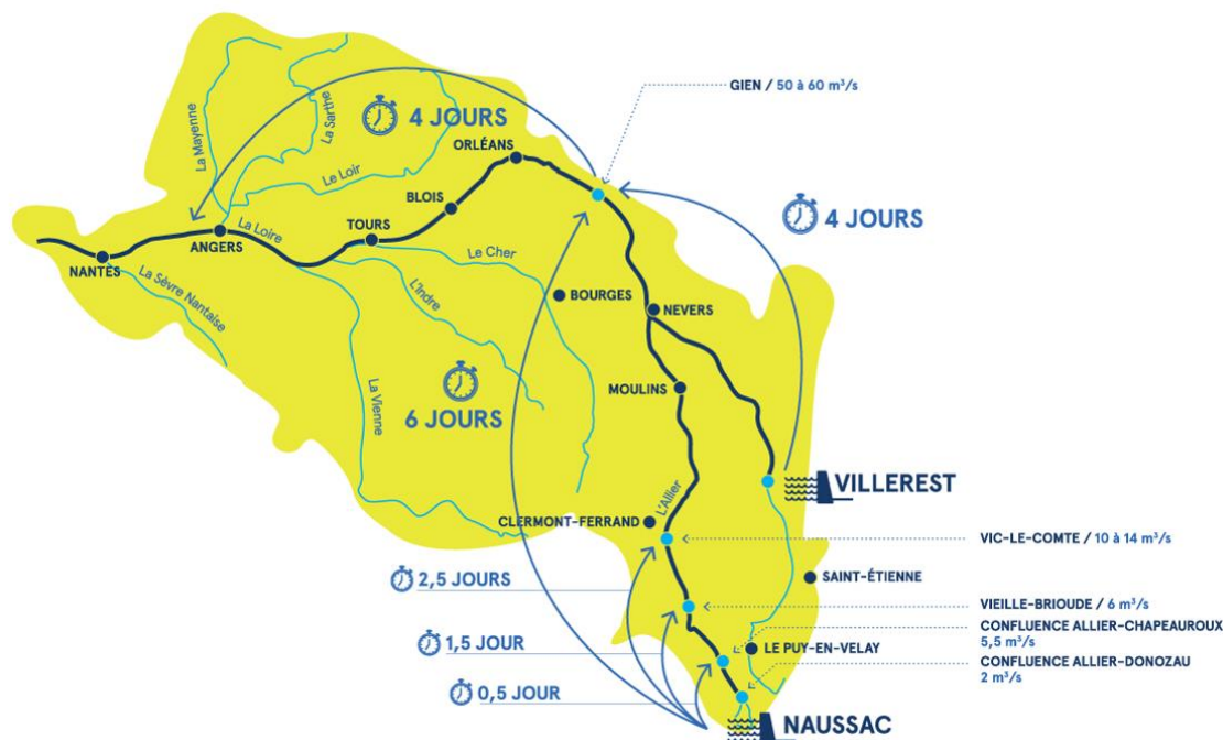
Stations de référence et Objectifs de soutien d'étiage (OSE) par les barrages de Naussac et Villerest
